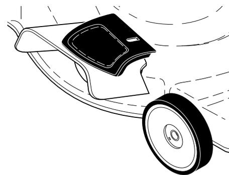
**ATTENTION:** N'utilisez pas votre tondeuse à gazon sans bouchon de broyeuse arrière ou bouchon en place ou ramasse-herbe approuvé en place. Ne tentez jamais à utiliser la tondeuse à gazon quand la porte arrière est enlevée ou ouverte.
