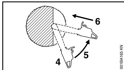
El corte por penetración se hace con la punta de la espada. Comience el corte aplicando la parte inferior de la punta de la espada contra el árbol en un ángulo. Corte hasta que la profundidad de la entalla sea casi igual que el ancho de la espada. En seguida, alinee la sierra en el sentido en que se va a cortar el rebajo.
