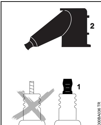
**!** Para reducir el riesgo de incendios y lesiones por quemadura, use solamente bujías autorizadas por STIHL. Siempre encaje un casquillo (2) del tamaño correcto bien ajustado en el borne (1) de la bujía. (Nota: Si el borne tiene una tuerca adaptadora SAE desprendible, colóquela.) Una conexión suelta entre el casquillo de la bujía y el conector del alambre de encendido puede formar un arco eléctrico, inflamar los vapores combustibles y finalmente causar un incendio.
