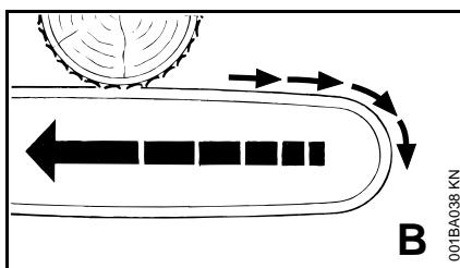
El rechazo ocurre cuando la cadena en la parte superior de la espada se detiene repentinamente cuando queda aprisionada, retenida o choca con algún objeto extraño en la madera. Como reacción, la cadena impulsa repentinamente la sierra hacia atrás contra el operador y puede causar la pérdida del control de la sierra. El rechazo frecuentemente ocurre cuando se utiliza la parte superior de la espada para hacer los cortes.
