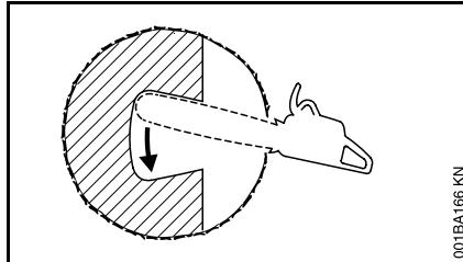
Agrande el corte por penetración como se muestra en la ilustración.
