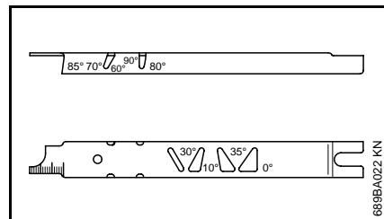
Utilice un calibrador de rectificación STIHL (accesorio especial – vea la tabla "Herramientas de afilado"). Esta es una herramienta universal para revisar los ángulos de rectificación y de la placa lateral, el ajuste de los calibradores de profundidad y el largo de los cortadores. Además, limpia la ranura de la espada y los agujeros de entrada de aceite.
