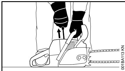
Con el **primer método** recomendado, la motosierra se arranca apoyada en el suelo. Asegúrese que el freno de la cadena esté aplicado (vea el capítulo "Freno de la cadena" en el manual de instrucciones) y apoye la motosierra sobre terreno firme u otra superficie sólida en un lugar abierto. Mantenga el equilibrio y elija un buen punto de apoyo para los pies.
