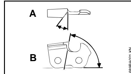
El paso de la cadena (por ejemplo:  $\frac{3}{8}$  pulg) se encuentra marcado en el lado del calibrador de profundidad de cada cortador.
