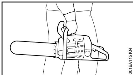
solamente en posición horizontal. Agarre el mango delantero de una manera que mantenga la máquina equilibrada horizontalmente. Mantenga el silenciador caliente lejos de su cuerpo y el accesorio de corte detrás de usted.
