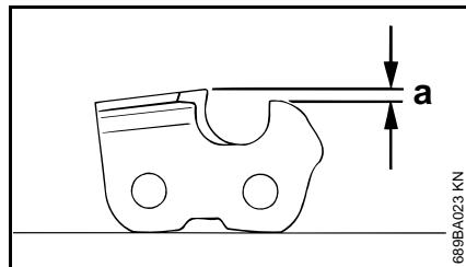
El calibrador de profundidad determina la altura a la cual el cortador penetra en la madera y por lo tanto determina el espesor de la viruta que se quita.
