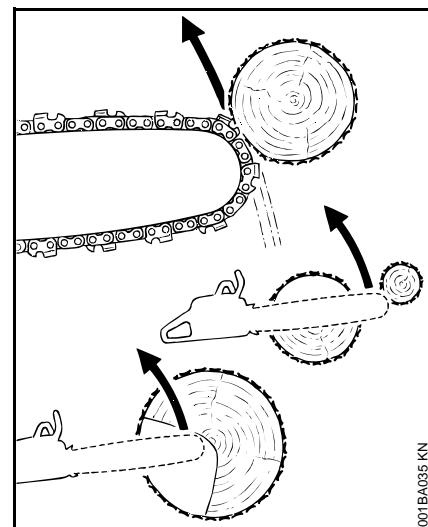
La reacción de la fuerza de corte de la cadena causa una fuerza de rotación en la motosierra en sentido contrario al movimiento de la cadena. Esto puede lanzar repentinamente la espada hacia arriba y hacia atrás describiendo un arco descontrolado, principalmente en el plano de la espada. En algunas circunstancias de corte, la espada se desplaza hacia el operador causándole lesiones graves o mortales.
